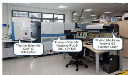
図2. シングル四重極型ICP-MS(モデル名:iCAP Qc)、二重収束型高分解能マルチコレクタICP-MS(モデル名:NEPTUNE Plus)、レーザーアブレーション(モデル名:Analyte G2)外観図
