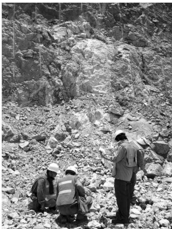
図1 タイ北部の浅熱水性金鉱床で含金石英脈（中央白色部）のサンプルを観察・採集しております。縦に刻まれた溝は発破用ダイナマイトを仕込むためのボーリング跡です。
