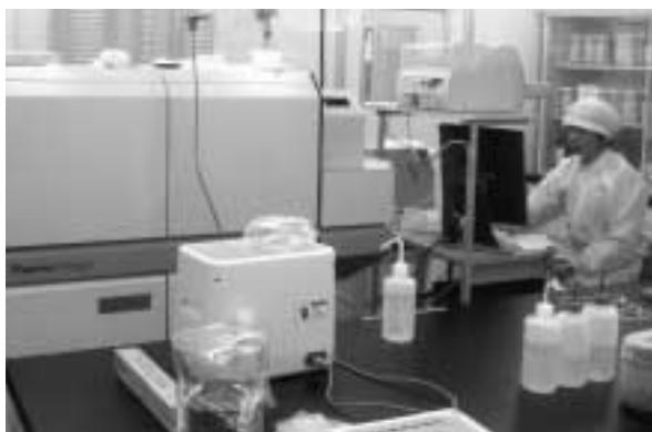
写真2 誘導結合型プラズマ質量分析計（ELEMENT II サーモエレクトロン社製；Aridus 脱溶媒装置 CETAC 接続）を操作中の柏麗麗技術研究員
