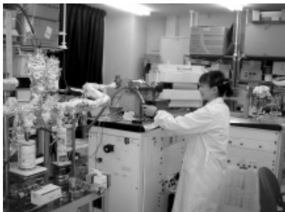
図3：希ガス質量分析装置（GV Instruments 社製 GVI 5400）で作業中。
