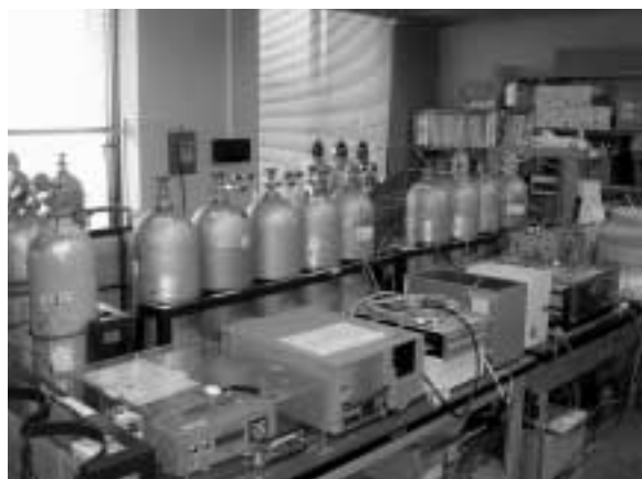
写真2 二酸化炭素標準ガス検定装置。奥に並ぶボンベは二酸化炭素の標準ガス。
